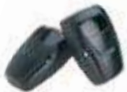
900OPTIC Jeu de photocellules à rayons infrarouges 12/24 V en applique, orientables +/- 15°, synchronisable, maxi 20 m
