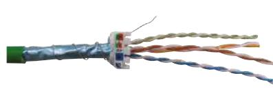
Passer les fils du câble et le drain dans le passe fils comme montré sur la photo.
