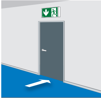
Un luminaire au dessus de chaque sortie de secours
