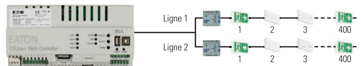
Installation typique max. 4 lignes de 200 blocs autonomes chacune (ci-dessus) ou 2 lignes de 400 blocs chacune (ci-dessous).
