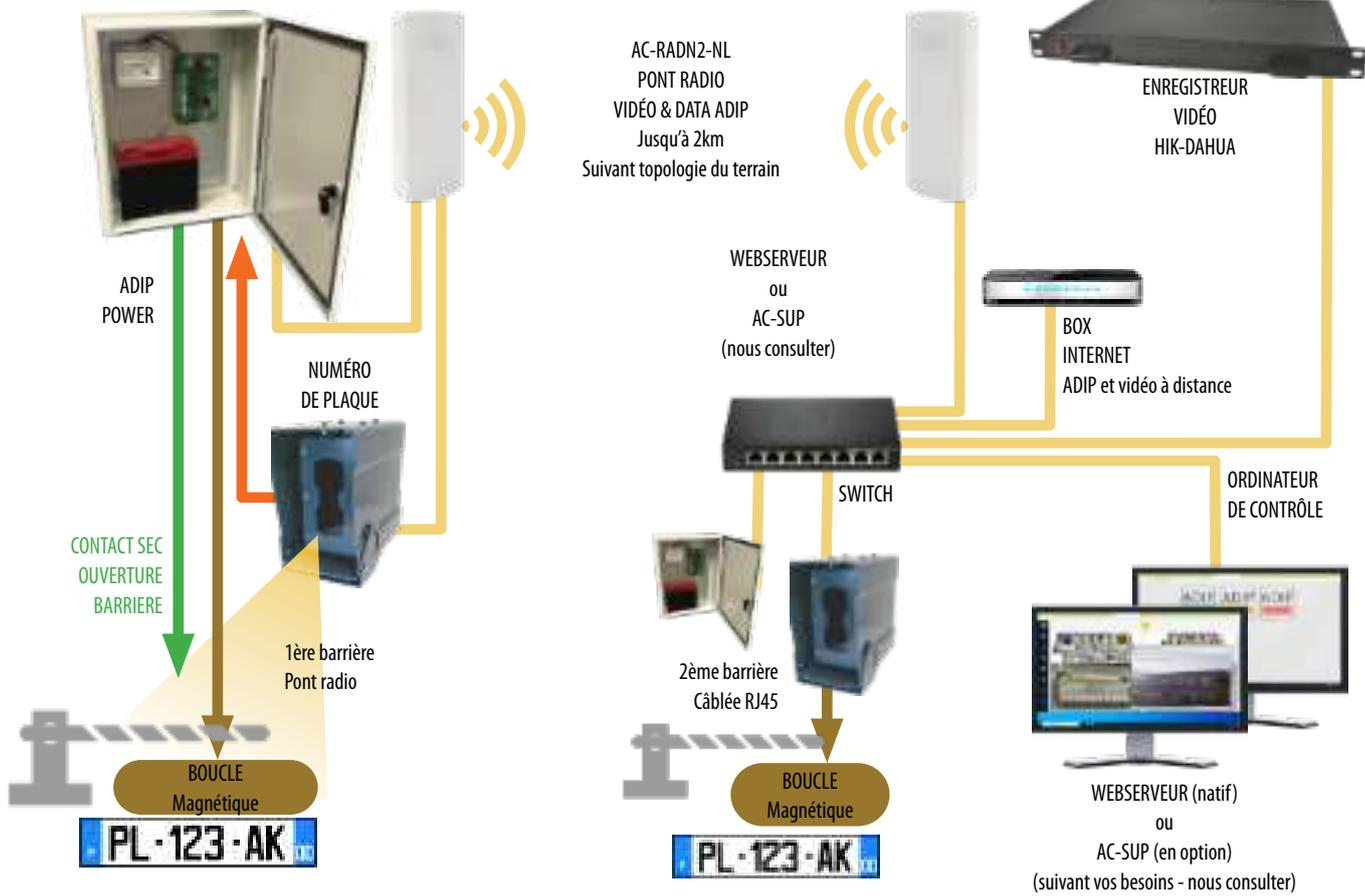
Schéma pour entrée sur lecture de plaque. La boucle magnétique active la lecture des plaques.
