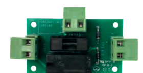
CDBEDAS-E Module de commande de DAS à émission Ce module nécessite l'utilisation d'une alimentation externe. Il permet la commande de DAS lorsque la puissance nécessaire est supérieure à celle fournie par la centrale ou si la tension de commande des DAS est différente de 24V.
