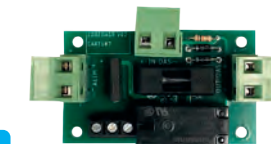
CDBEDAS-R Module de commande de DAS à rupture Ce module nécessite l'utilisation d'une alimentation externe. Ce module est indispensable pour la commande de DAS à rupture ou commande de PCF de recouplement à rupture.
