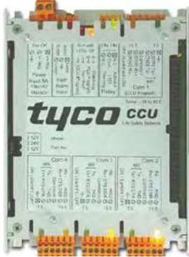
L'interface CCU3 fournit une interface Modbus à un certain nombre de centrales ZX sur un réseau MZXNet.
