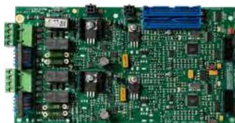
La carte XLM800 permet d'augmenter la capacité des E.C.S. ZX4F et ZX4-BB à 2 circuits de détection (possibilité d'ajouter jusqu'à 3 cartes XLM800 par E.C.S.). Cette carte est également compatible avec le C.M.S.I. ZXA ainsi que sa centrale d'extension ZXA-BB, permettant d'augmenter le nombre de voie de transmission (possibilité d'ajouter jusqu'à 3 cartes XLM800 par C.M.S.I.). La carte XLM800 se superpose sur la carte mère FIM802 des centrales, ou sur une carte XLM800 existante.
