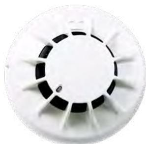
Les détecteurs de chaleur de la Série 700 comprennent des types thermo-vélocimétrique et thermostatique de 60°C et 90°C. Ils détectent les élévations anormales de la température et les températures élevées de 60°C et 90°C.
