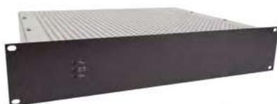
Alimentation Electrique de Sécurité pour les systèmes de sonorisation de sécurité, conforme à la norme EN54-4. Conçue pour charger des batteries au plomb et fournir une alimentation. Comprend 2 sorties chargeur avec une puissance maximale de 960W. Il prend en charge 1 NEO-8060 avec 2 batteries 12 V 45 Ah (batteries non fournies).
