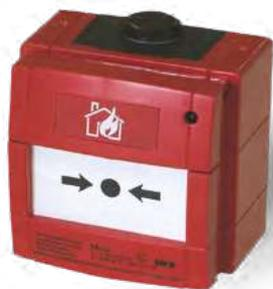
Le MCP220Ex est un déclencheur manuel d'alarme conventionnel à sécurité intrinsèque certifié ATEX. Il doit être raccordé sur l'isolateur galvanique MTL5561.
