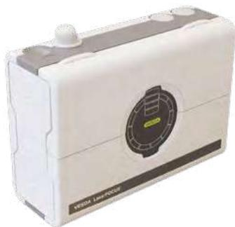
Le détecteur VESDA LaserFOCUS fonctionne en utilisant un aspirateur très efficace qui aspire continuellement de l'air dans sa chambre de détection laser via un réseau de tuyaux. Le résultat est un processus de détection incontesté capable de fournir des performances de détection de fumée très précoces fiables.
