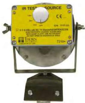
Le testeur T210+ permet de tester les détecteurs de flamme infrarouge. L'appareil peut être monté sur le tube adaptateur SOLO 704. Il est constitué d'un boîtier robuste en polyester homologué pour les niveaux de sécurité renforcés (pour les zones 1 et 2, gaz GPIIC). Pour vérifier la sensibilité et le temps de réponse, le T210+ est maintenu contre la face avant du détecteur de flamme à tester.
