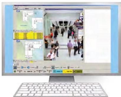
La fonction de vidéo IP permet d'afficher des images en temps réel de la zone à risques en cas d'alarme ou d'un défaut. La capture vidéo de la zone concernée apparaît automatiquement à l'écran, ce qui permet d'évaluer rapidement la gravité de la situation et de prendre les mesures appropriées.
