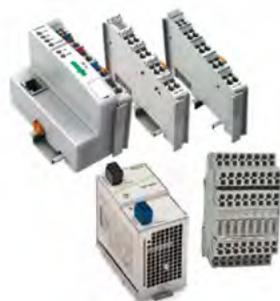
Si l'application nécessite de piloter plus que les 40 sorties relais du détecteur SensorLaser Plus, ce kit de contrôleur de relais doit être utilisé. Il comprend un contrôleur de relais, un module d'entrées/sorties numériques 8 canaux, un module 8 relais et un bloc alimentation. Le contrôleur de relais peut être étendu pour atteindre 256 relais supplémentaires, en ajoutant des kits d'extension A1201A.
