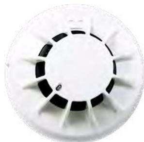
Le détecteur de fumée 701P fonctionne en détectant la diffusion optique des particules de fumée générées par un incendie. Le microprocesseur à l'intérieur du détecteur permet une compensation de seuil, ce qui signifie que le détecteur ajuste les niveaux de sensibilité pour compenser les niveaux de poussière et de saleté dans la chambre, ce qui réduit les alarmes intempestives et prolonge la durée de vie du détecteur.
