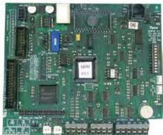
Le module d'interface MPM800 offre diverses capacités d'extension via le bus déporté (RBUS). Il est commercialisé comme une carte autonome, mais il est aussi intégré dans le coffret ZXA-32 pour gérer les cartes d'affichage DAS800. Le module MPM800 peut gérer jusqu'à 80 Entrées/Sorties. Le module MPM800 comporte aussi une interface pour le raccordement d'une imprimante. 15 modules MPM800 peuvent être connectés sur un E.C.S. ou sur un C.M.S.I. adressable.
