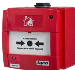
Le déclencheur manuel d'alarme adressable MCP830 est équipé d'une membrane déformable et d'un voyant d'état. Une clé en plastique multifonctions est fournie avec le D.M.A. pour effectuer le test et le réarmement. Le D.M.A. MCP830 intègre un isolateur de court-circuit. Avec un indice de protection IP 67, le D.M.A. MCP830 peut être installé à l'extérieur du bâtiment.
