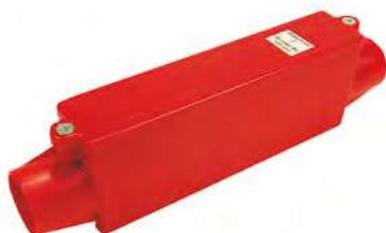
Le filtre est simplement installé dans le réseau d'aspiration après le détecteur par aspiration, où il peut remplir facilement la fonction d'un préfiltre à deux étages remplaçables. Dans les bâtiments où la charge de saleté ou de poussière est élevée, cela permet d'éviter que le filtre intégré au détecteur par aspiration ne s'encrasse trop rapidement. Il peut être monté verticalement ou horizontalement et sa conception spéciale l'empêche d'affecter la vitesse du flux d'air.
