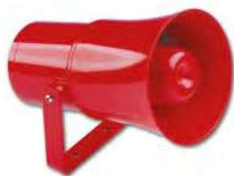
Le diffuseur sonore DB3 dispose d'une puissance sonore jusqu'à 115dB(A) à 1m, variable selon le son sélectionné. Ce diffuseur est conçu pour les applications en intérieur ou en extérieur, adapté à l'industrie. Il est certifié EN54-3 et est associé avec l'ensemble de la gamme ZETTLER, dont le C.M.S.I. adressable ZXA.
