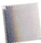
Le réflecteur est utilisé avec le détecteur de fumée FIRERAY 5000. Jusqu'à 50 m, un réflecteur est nécessaire. De 50 à 100 m, quatre réflecteurs sont nécessaires.
