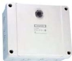
Le dispositif d'entrées adressable CIM800 est équipé de 2 entrées surveillées programmables. Il est utilisé pour la reprise d'informations venant d'un équipement d'alimentation électrique, d'un détecteur linéaire de fumée, d'un détecteur par aspiration de fumée, d'une sonde de température ou venant d'un système Sprinkler.
