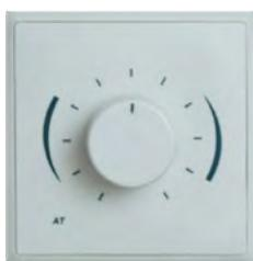
Atténuateur avec 10 niveaux d'atténuation de 3dB (puissance autorisée: 12W @100V).
