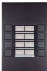
MPS-8K est un clavier d'extension pour le micro MPS-8Z. Il ajoute 8 boutons programmables supplémentaires qui peuvent être attribués à différentes zones par le logiciel de configuration NEO. Il comprend un couvercle transparent pour l'indication des noms de zone. Jusqu'à 8 unités MPS-8K par microphone MPS-8Z.
