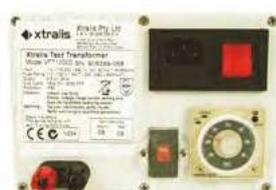
Coffret de test de combustion de fil conçue pour chauffer une longueur mesurée de fil spécial afin de produire de la fumée. Ce coffret est utilisé pour tester le temps de transport et les performances des détecteurs par aspiration de fumée.
