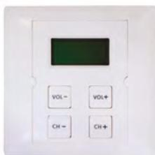
VCC-64 permet de sélectionner 99 canaux programmables et de contrôler le volume (0-9). Il est généralement installé localement et connecté par le biais d'un bus RS-485 vers le système. Il dispose d'une sélection de source, de contrôle de volume et d'une fonction de verrouillage.
