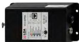
VCC-64PSK est un adaptateur de communication et d'alimentation électrique RJ-45, qui permet de connecter 10 contrôleurs VCC-64 sur une distance de 100 m en utilisant un câble Ethernet.
