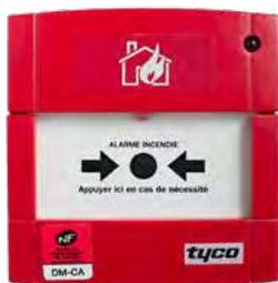
Le déclencheur manuel d'alarme adressable MCP820 est équipé d'une membrane déformable et d'un voyant d'état. Une clé en plastique multifonctions est fournie avec le D.M.A. pour effectuer le test et le réarmement. Le D.M.A. MCP820 intègre un isolateur de court-circuit. Il peut être monté en saillie ou encastré, à l'intérieur du bâtiment. Le déclencheur manuel d'alarme adressable MCP820 est associé aux centrales ZX.
