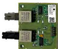
Les modules FOM800 sont des convertisseurs RS-485/Fibre optique multimode. Ils permettent d'augmenter la distance entre chaque nœud ou entre chaque équipement centrale (E.C.S, C.M.S.I.) jusqu'à 5 000m en utilisant des fibres multimodes 62,5/125. Les modules FOM800 se connectent très facilement sur la carte d'interface réseau TLI800EN (2x FOM800 par carte TLI800EN).
