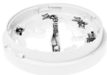
Le socle 4B-C est conçu spécialement pour la gamme de détecteur Série 850. Ce socle est équipé d'un commutateur qui permet d'assurer la continuité de la boucle en cas de retrait du détecteur. Un dispositif de verrouillage du détecteur est fourni avec chaque socle.
