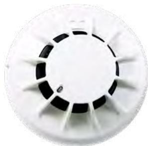
Le détecteur optique/thermique 701PH fonctionne en détectant la diffusion optique des particules de fumée générées dans un incendie. Un taux d'augmentation rapide de la température augmente la sensibilité de détection de la fumée ; pour des conditions ambiantes normales, le détecteur optique haute performance se comporte comme un détecteur optique normal. Le 701PH est conforme à la norme EN54-29, une norme multi-capteurs pour la fumée et la chaleur.
