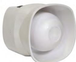
Le diffuseur sonore DS-SYV est un dispositif sonore d'alarme feu (D.S.A.F.) avec le signal sonore d'évacuation d'urgence NFS32-001 et à message pré-enregistré. Ce diffuseur sonore est particulièrement utilisé dans les salles de spectacles, les cinémas et les magasins. Il est conforme à la classe B au sens de la norme NFS32-001 et de type A. Il est certifié NF EN54-3 et est associé avec l'ensemble de la gamme ZETTLER, dont le C.M.S.I. adressable ZXA.
