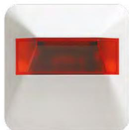
L'indicateur d'action 801HL permet d'indiquer l'origine d'une alarme incendie. Grâce à sa fenêtre rouge en prisme, il peut être vu dans un couloir sur 180°. Le 801HL permet deux raccordements, individuel pour un détecteur et commun pour quatre détecteurs.
