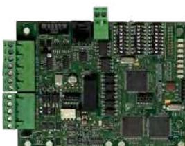
La carte TLI800EN permet la communication entre les E.C.S. et les C.M.S.I. Zettler suivant le principe peer to peer. Le réseau de communication peut gérer jusqu'à 99 nœuds sans l'obligation d'avoir une centrale maître. Si la communication dans le réseau est interrompue, tous les points d'accès du réseau continueront à fonctionner en tant que centrales incendie autonomes.
