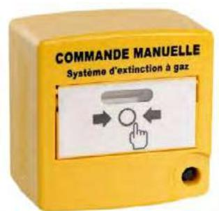
Le déclencheur manuel de type B "Commande manuelle" est un dispositif requis pour les systèmes d'extinction automatique à gaz. Ce boîtier est installé à proximité de chaque issue principale et issue d'évacuation balisée d'un local protégé par un système d'extinction. Son déclenchement est à double action. Livré avec clé "outil de test et de réarmement".
