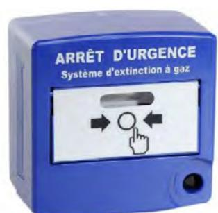
Le déclencheur manuel de type B "ARRÊT D'URGENCE" est un dispositif requis uniquement pour les installations d'extinction automatique CO<sub>2</sub> et pour les installations d'extinction automatique à gaz inertes et inhibiteurs quand le seuil LOAEL (dose minimale avec effet nocif observé) est dépassé.
