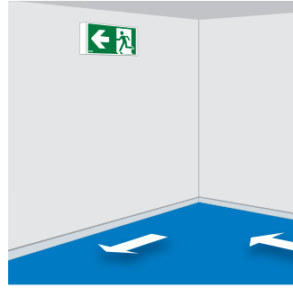
1 luminaire à chaque changement de direction
