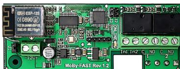
La carte LAN Wi-fi avec service CLOUD permet la connexion câblée ou sans fil. Grâce au service CLOUD extrêmement sécurisé, fourni gratuitement, il permet, en plus de la surveillance des systèmes, d'activer à distance les commandes d'armement, de tir et de réglage en secondes du brouillard.
