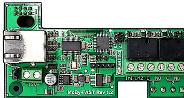
La carte LAN avec service CLOUD est utile pour contrôler les machines et pour le diagnostic. C'est un grand avantage pour tous les installateurs qui peuvent contrôler à distance l'état des systèmes de brouillard installés et l'éventuelle nécessité de programmer une intervention de maintenance.
