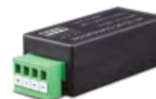
ENTRÉE : 20~30V AC SORTIE : 12V DC, 1.0 AMP DISTANCE DE TRANSMISSION JUSQU'À 500M (EN UTILISANT L'ALIMENTATION PR-24V1A-AC )
