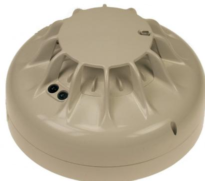
Le détecteur de chaleur complète la gamme, il peut fonctionner en mode statique ou thermovélocimétrique, avec plusieurs sensibilités approuvées. Il est utilisé le plus souvent dans des zones avec des concentrations élevées de poussière ou lorsque l'environnement empêche d'utiliser des détecteurs de fumée.
