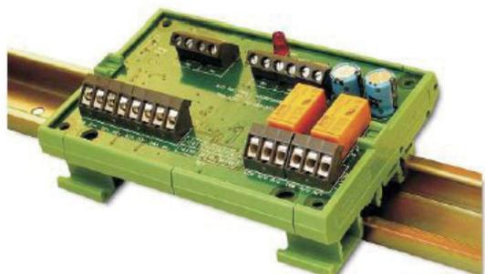
Le MIO800 est un module interface polyvalent utilisé avec les systèmes de détection d'incendie MZX. Il permet d'établir plusieurs connexions d'entrée et de sortie entre un équipement extérieur et la boucle numérique MZX. Trois entrées et quatre sorties sont fournies. Chaque entrée et sortie peuvent être programmés indépendamment en utilisant l'outil de configuration MZX Consys afin de fournir des fonctions personnalisées.
