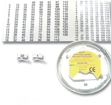
Les détecteurs de la série 800 positionnent automatiquement l'indicateur d'adresse dans le socle du détecteur lorsque le détecteur est enbroché dans son socle. Lorsque le détecteur est enlevé, l'indicateur d'adresse reste sur le socle et ainsi les détecteurs ne seront pas remis accidentellement sur le mauvais socle après l'entretien ou la réparation.
