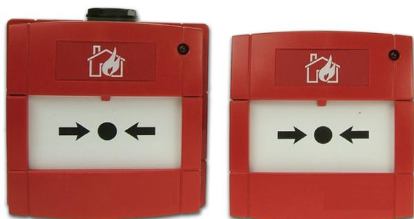
Gamme complète de déclencheurs manuels à utiliser avec les systèmes adressables. Tous les déclencheurs manuels sont conçus pour qu'un signal d'alarme se génère lorsqu'on en casse la vitre. Ceci déclenche un contacteur, ce qui est indiqué par un voyant LED. Si nécessaire, en option, un couvercle articulé transparent peut être installé pour assurer la protection contre une manœuvre accidentelle.
