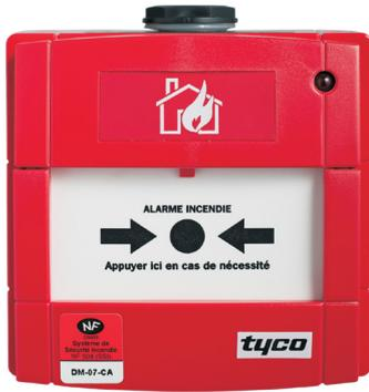
Le CP830 est un déclencheur manuel adressable MX pour extérieur avec voyant LED d'état. Le CP830 est homologué selon EN54-11. Le CP830 assure des communications très rapides vers la centrale MZX d'un système de détection incendie.
