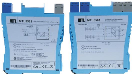
La MTL5561 est une interface à deux voies pour l'utilisation avec des détecteurs conventionnels placés dans les zones dangereuses. Cet isolateur galvanique dispose du marquage CE et remplace la barrière MTL3043. Il permet de connecter des charges dans des zones ATEX 0, IIC, T4-T6 s'il est convenablement certifié.
