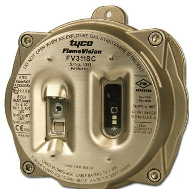
Les FlameVision FV300 sont des détecteurs utilisant une matrice de 256 capteurs infrarouges pour détecter la flamme et localiser son emplacement dans le champ de vision du détecteur. De plus, une caméra de surveillance incorporée peut transmettre "le champ de vision du détecteur" de la surface protégée à un moniteur vidéo. La position exacte d'où provient l'alarme sera superposée sur l'image de la caméra de vidéosurveillance.
