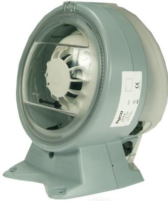
Les détecteurs de gaine DPK4 et DPK4I ont été développés pour détecter la fumée dans les gaines de ventilation. Ils offrent des avantages importants en termes de performance et d'installation. Le système comprend un seul tube de prélèvement et un logement spécialement conçu pour optimiser le débit d'air à travers le détecteur de fumée et il convient pour les conduits d'air entrant, sortant et de circulation, qu'il s'agisse de systèmes de ventilation ou de climatisation.
