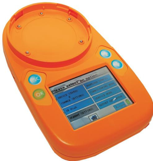
L'outil d'aide à la mise en service communique avec les détecteurs série 850 à l'aide d'une liaison sans fil infrarouge bidirectionnelle. Les données de mise en service sont conservées dans le 850 EMT et un message demandera au technicien de sélectionner et confirmer les paramètres de configuration, ce qui donnera un document de mise en service s'appuyant sur des preuves et pouvant être téléchargé à partir du programmeur.
