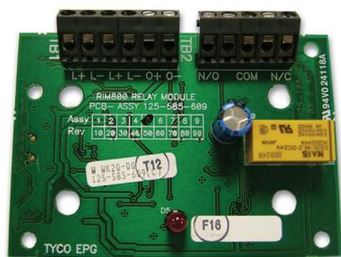
RIM800 fournit une sortie à relais NO/NF depuis la boucle adressable MZX pouvant être programmée pour diverses applications. Il permet de commuter la tension secteur lorsqu'il est utilisé avec le HVR800.
