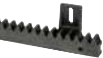
400CN Crémaillère en nylon renforcée avec noyau en acier 22x22 (max. 800 kg) Pcs / Botte de 10 m
