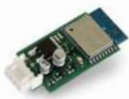
250T-WIFI Dispositif de connexion WIFI 2,4 GHz qui permet d'utiliser le portail à distance grâce à l'application TauApp pour programmer et contrôler les centrales de commande
