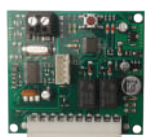
250RXSM2 Récepteur radio à autoapprentissage, 433,92 MHz, bicanal embrochable (mémoire 14 codes)
