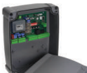
750D770M Centrale de commande pour 1-2 moteurs 230 V, avec ralentissement, récepteur radio à code variable 433,92 MHz intégrés, et coffret
