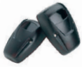
900OPTIC Jeu de photocellules à rayons infrarouges 12/24 V en applique, orientables +/- 15°, synchronisable, maxi 20 m
